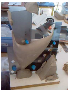
Ph. 7, MàJ déc.2010 (à venir). Moule en raccourci percé pour faciliter la répartition du plâtre
