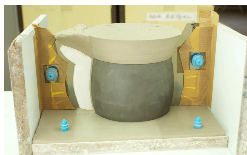
Ph. 8, MàJ déc.2010 (à venir) Moule en raccourci avec Préscis pour rigidifier les radios.
